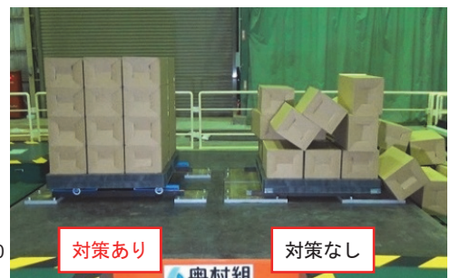
写真-1 振動台実験(加振終了後)
