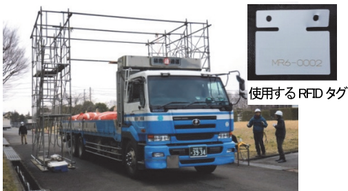
写真-1 RFID タグ読み込み実験状況
