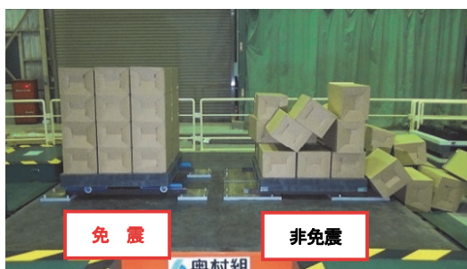
写真-3 振動台実験状況(加振終了後)
