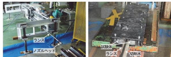
(a) ノズル自動送り装置 (b) 試験体固定治具
