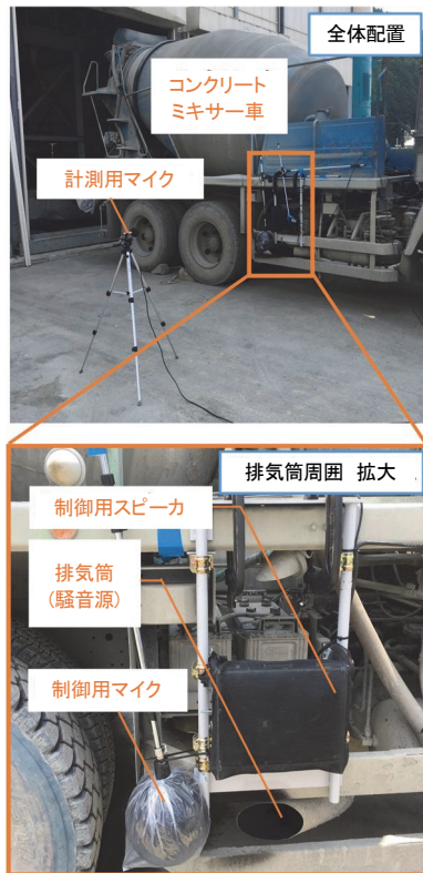
写真-1 アクティブ消音システムの適用状況 (コンクリートミキサー車)
