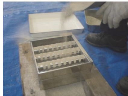
写真-3 格子型マグネットによる磁力選別
