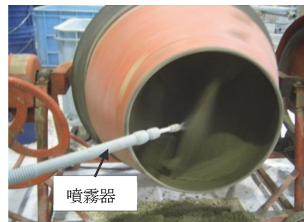
写真-1 模擬セシウム汚染土壌の調製
