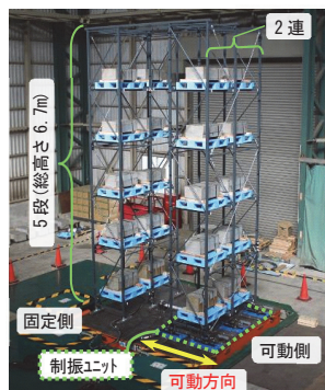
写真-2 振動台実験の状況
