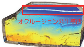
図-8 不整地走行用 MMS による現況モデル
