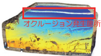
図-7 工事用道路走行用 MMS による現況モデル
