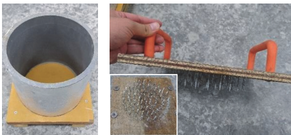
塩ビ管容器 表層の粗骨材を沈下させる剣山
