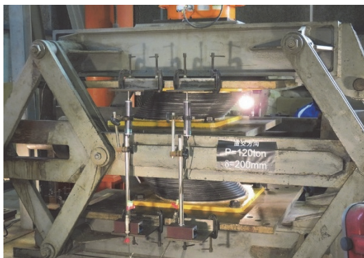
写真-2 圧縮せん断試験の状況
