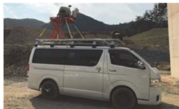
写真－1 工事用道路走行用 MMS
