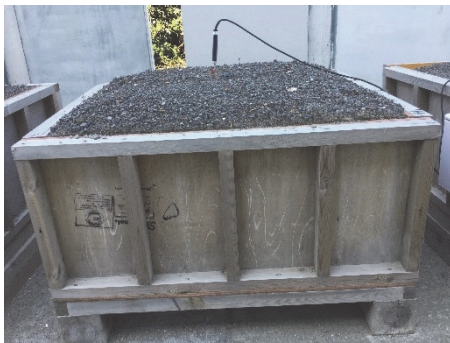
写真-6 天端からの土壌の隆起
