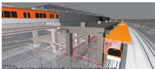
図-3 営業線直上施工
