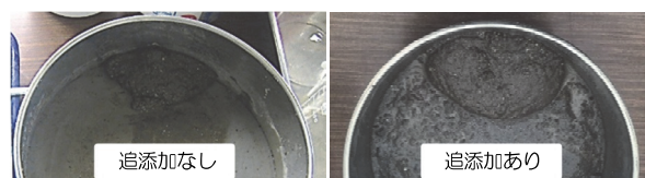
写真-9 改質材追添加による篩上残留物の変化
