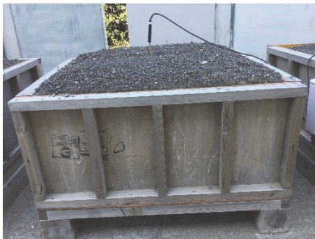
写真-6 天端からの土壌の隆起
