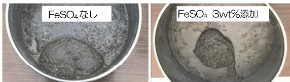
写真-10 FeSO 4 添加による改質材追添加した提供土壌の篩上残留物の変化
