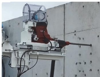
写真-7 小径用自動削孔装置の実験状況
