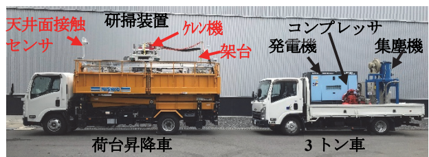
写真-8 研掃装置と施工状況
