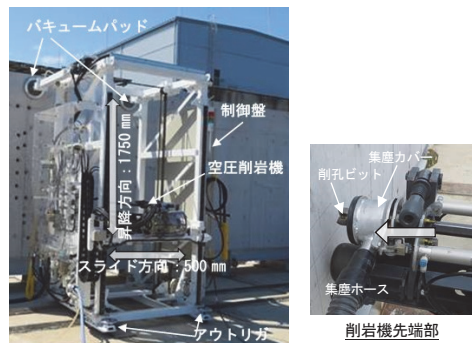
写真-1 大径用自動削孔装置
