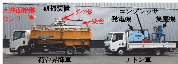
写真-8 研掃装置と施工状況
