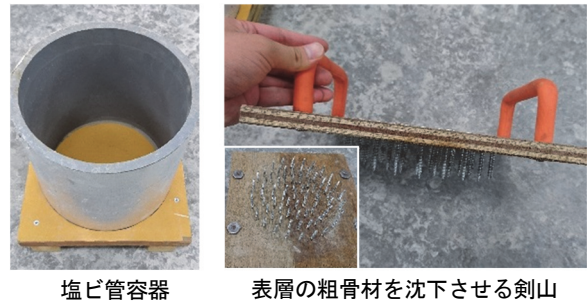
写真-1 供試体測定用の試験器具
