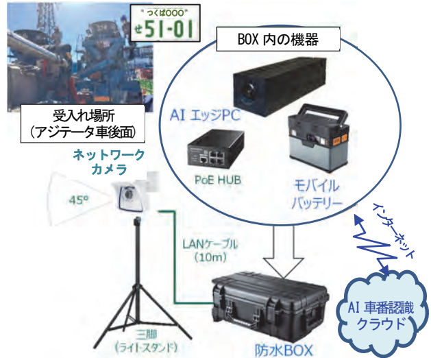
図-5 映像による AI 車番認識機能の構成
