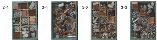
図-7 各実験ケースの模擬災害廃棄物の状態
