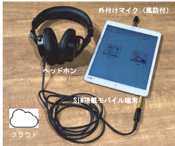
写真-2 システム機器（工事騒音評価時）
