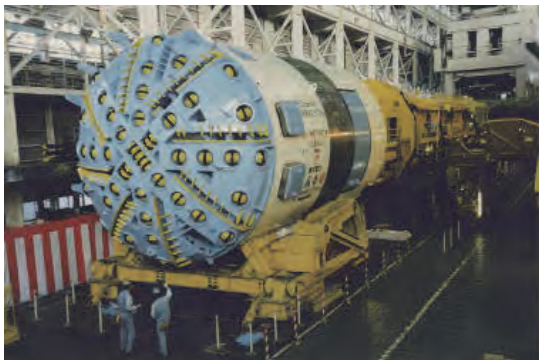
神流川発電所工事で使用した 全断面斜坑掘削TBM
