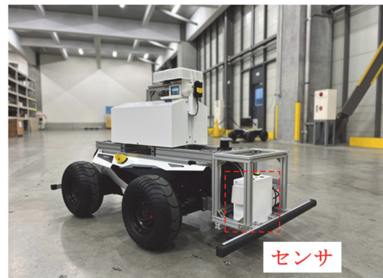
写真-1 センサ搭載型自律走行式ロボット
