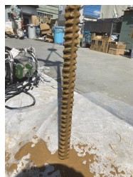
写真-1 鉄筋の安定液浸漬
