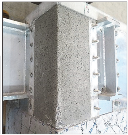
写真-2 ふさぎ板内コンクリートの状況 (K-2)
