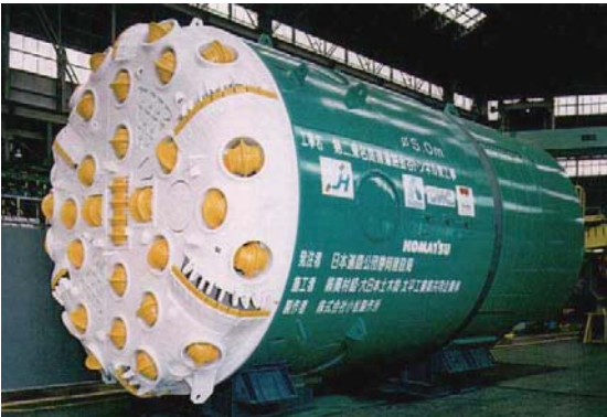
本システムを適用したTBM(第二東名金谷トンネル東工事)
